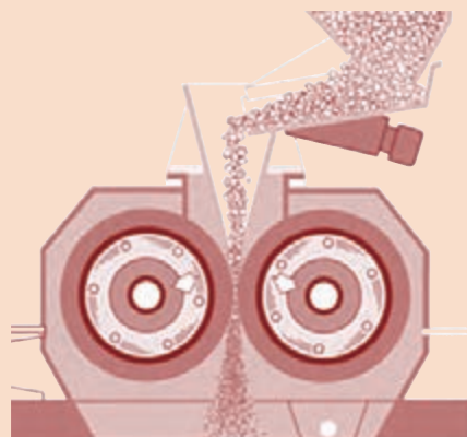
شکل ۳۰- جهت چرخش استوانه‌ها در سنگ‌شکن غلتکی
