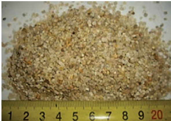
شکل ۶- دانه‌های ماسه سیلیسی قابل‌رؤیت با چشم
