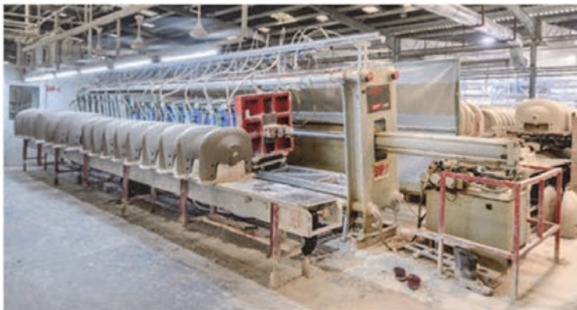
شکل ۶- ریخته‌گری دوغابی با فشار پایین
