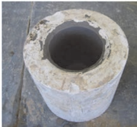
شکل ۹- قالب نمونه برای تعیین سرعت ریخته‌گری
