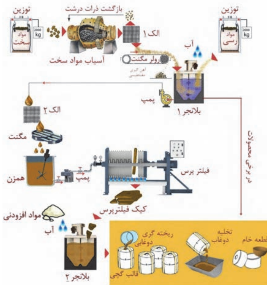
شکل ۱۱- فرایند ساخت دوغاب و شکل‌دهی قطعه
