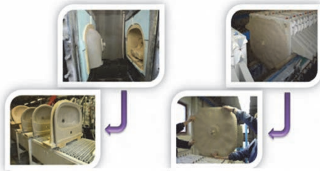
شکل ۵- الف) فیلترپرس ب) ریخته‌گری دوغابی تحت فشار
