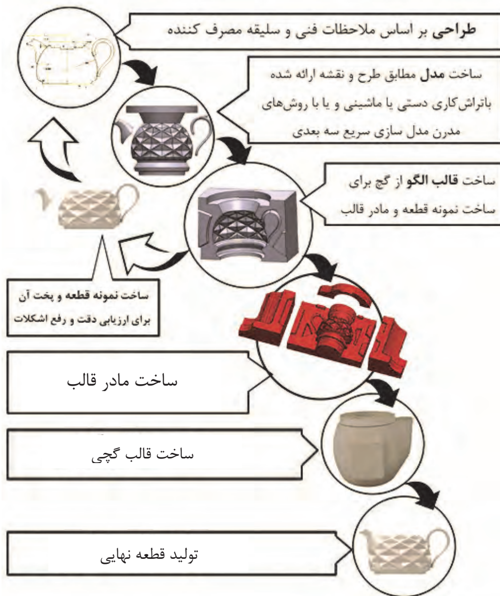
شکل ۶- مراحل ساخت قطعه سرامیکی
