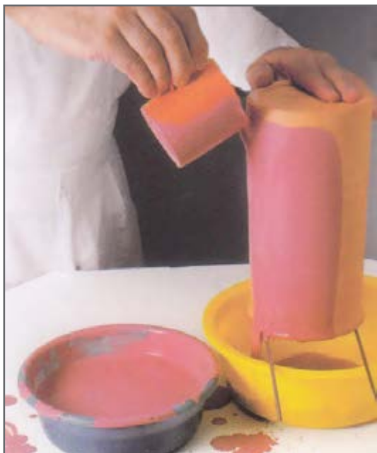
شکل ۱۴- اعمال لعاب به روش ریختنی
