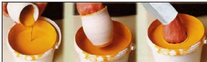
شکل ۱۹- لعاب‌زنی دستی و کارگاهی
