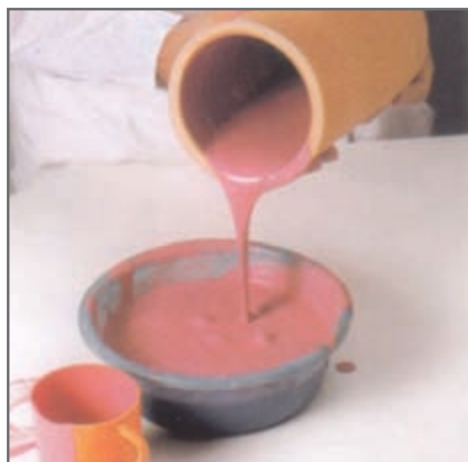
خارج کردن اضافی لعاب از داخل قطعه
