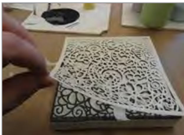
شکل ۳۴- لعاب‌زنی با روش چاپ استنسیل
