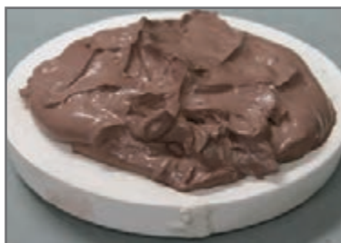
الف - گل پخش شده روی سطح گچ
