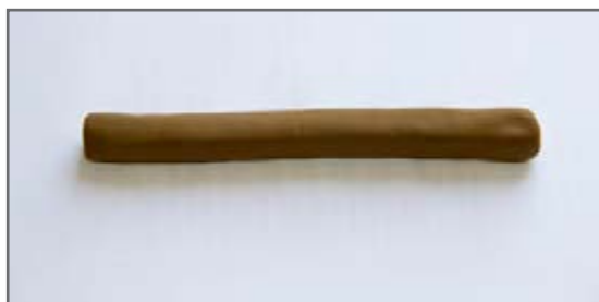
گل با شکل‌پذیری مناسب - بدون ترک
