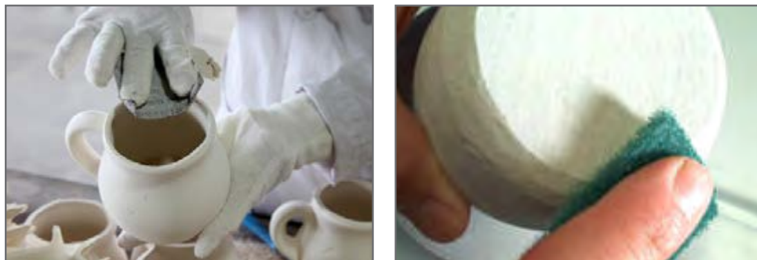
شکل ۹ - پرداخت خشک قطعه با اسکاچ و سنباده
