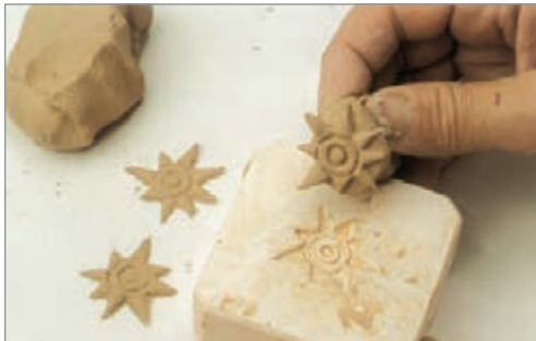
شکل ۱۳- فشار دادن مقداری گل درون قالب
