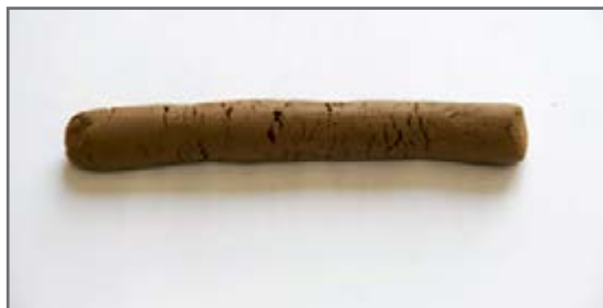
گل با شکل‌پذیری نامناسب - دارای ترک
