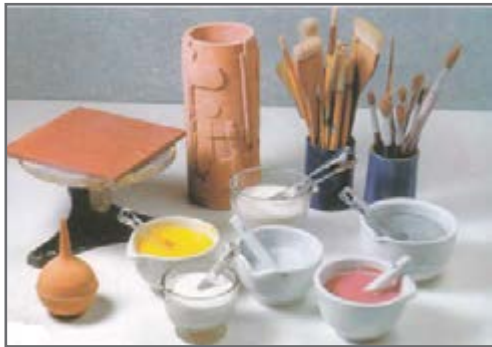
شکل ۱۰- تجهیزات مورد استفاده جهت لعاب‌زنی با قلم‌مو
