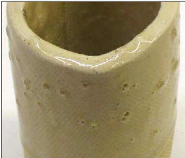
شکل ۳۴- عیب تاول زدن لعاب
