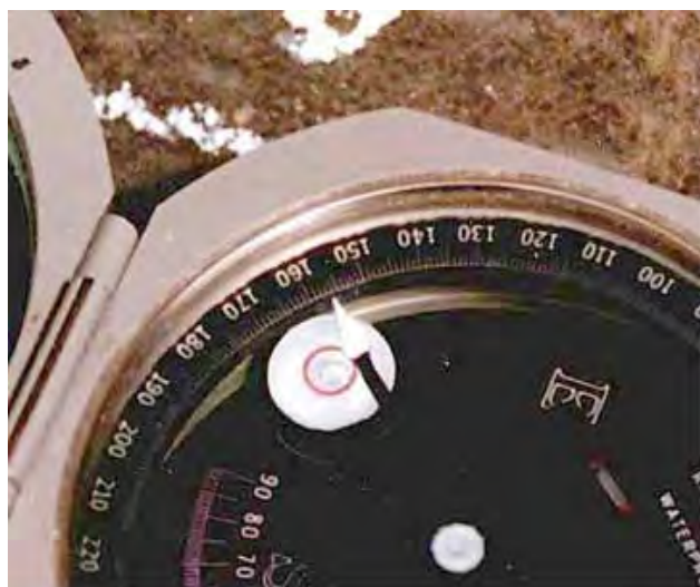
تراز کروی ( چشم گاو ) باید تنظیم شود
