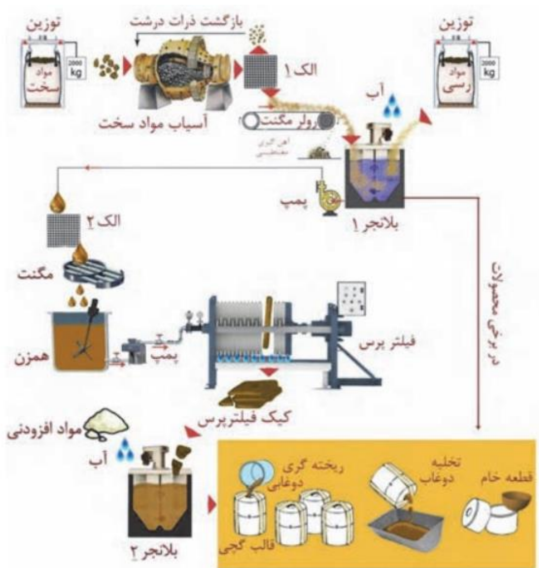
شکل ۱۱- فرایند ساخت دوغاب و شکل دهی قطعه
