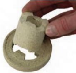
قرارگرفتن اتصال قلعه‌ای بر روی دیسک
