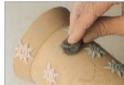
شکل ۱۴- برداخت بدنه پس از فرار دادن طرح
