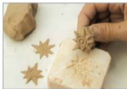
شکل ۱۳- فشار دادن مقداری گل درون قالب
