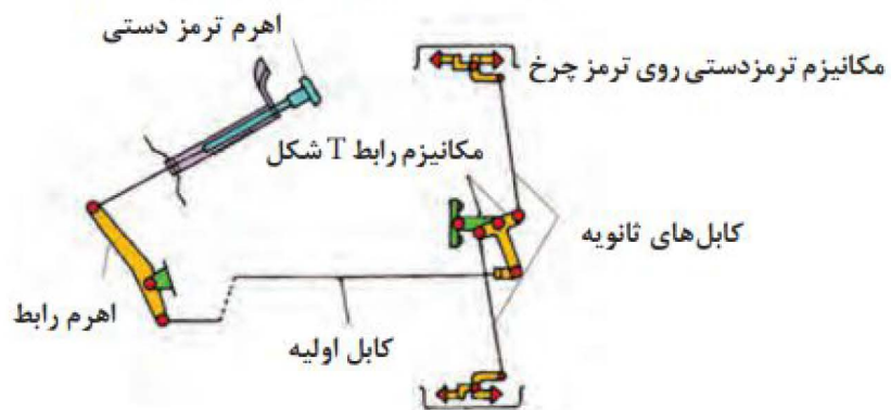
شکل ۲۱- مکانیزم ترمز پارک کابلی با واسط T شکل
