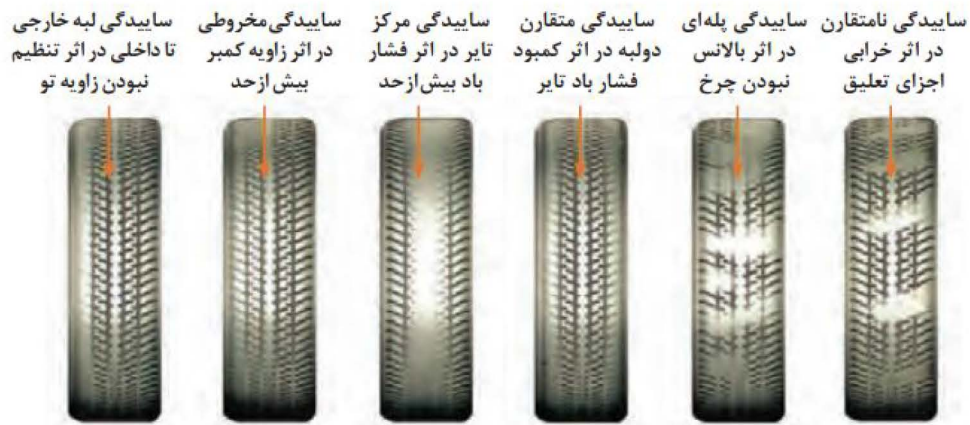
شکل ۳۱- لاستیک‌سایی در اثر تنظیم نبودن زوایای چرخ
