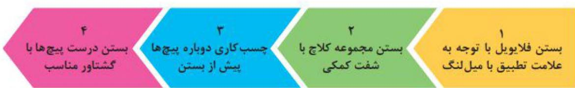
هنگام بستن صفحه کلاچ، فنرهای ضربه گیر صفحه کلاچ باید به سمت دیسک باشد. سطح لنت کلاچ کاملاً بر روی فلاپول بشیند.
