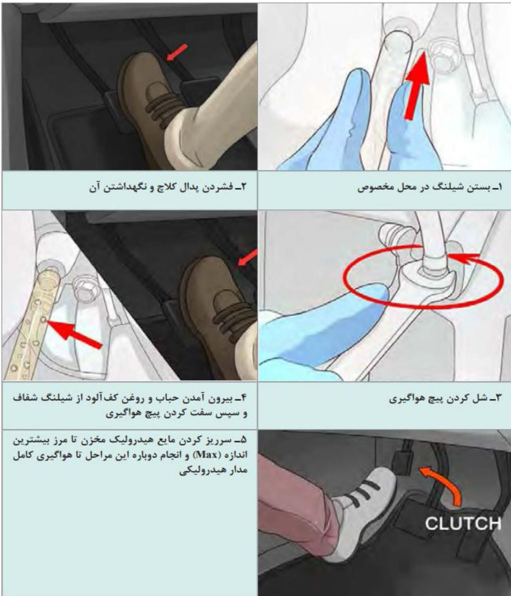
نکته: در تمام مخزن های مایع هیدرولیک کلاچ، مکانیزم تبادل فشار وجود دارد. هنگام بازدیدهای خودرو، باز بودن این مجرای تبادل فشار بررسی شود.
