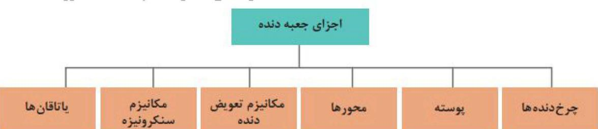
اصلی ترین و پرکاربرد ترین قطعات در جعبه دنده‌های دستی چرخ‌های دنده‌ها می‌باشند؛ که قابلیت آنها انتقال دور و گشتاور و همچنین تغییر در مقدار دور و گشتاور و جهت آن است. برای انتقال دور و گشتاور، حداقل به دو چرخ دنده نیاز است.
