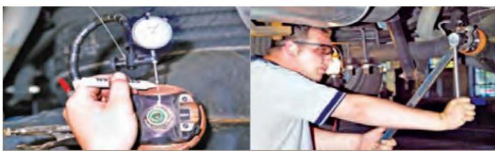
شکل ۳-۲۵- بررسی لنگی فلاتج و گشتاور سنجی مهره مرکزی دیفرانسیل
