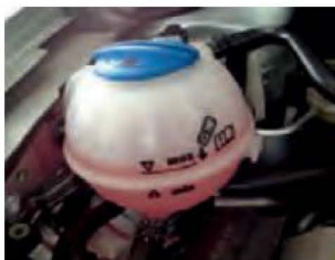
بررسی سطح مایع خنک‌کننده
