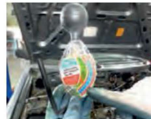
بررسی کیفیت مایع خنک‌کننده
