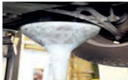
۲ مخزن جمع آوری روغن کارکرده زیر خودرو قرار گیرد.
