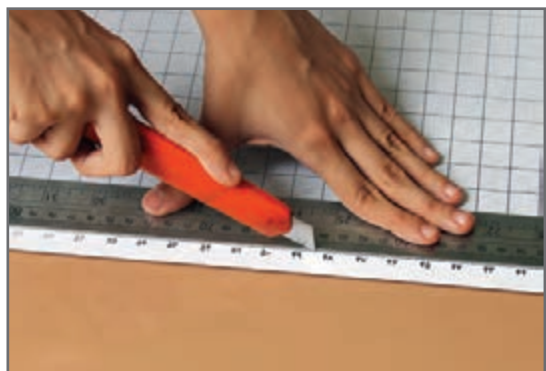
شکل ۴۰-۱- روش برش لبه اضافی کاغذ با کاتر
