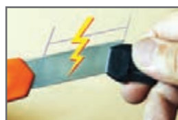
شکل ۱-۱۳- خطر در شکستن تیغه و پرتاب شدن قطعات آن به طرف صورت انسان
