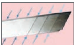
شکل ۱-۸- شیارهای روی تیغه کاتر
