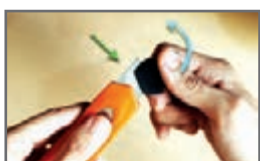
شکل ۱-۱۱- روش شکستن تیغه کاتر
