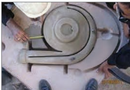
شکل ۳- قالب درجه زیرین یک پوسته دمنده هوا
