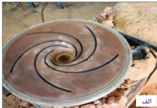
شکل ۱۶- الف) جعبه ماهیچه CO 2 و ب) ماهیچه خارج شده از آن
