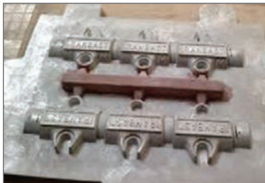
شکل ۶- راهبار و راهبارها روی مدل صفحه‌ای
