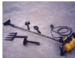
شکل ۱۲- کوبه ماشینی با سرهای قابل تعویض
