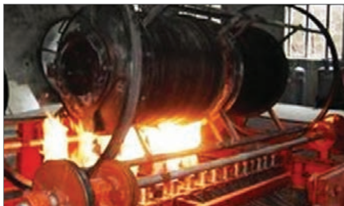
شکل ۱۳- پیش گرم کردن قالب‌های فلزی با استفاده از دستگاه‌های گرم‌کننده
