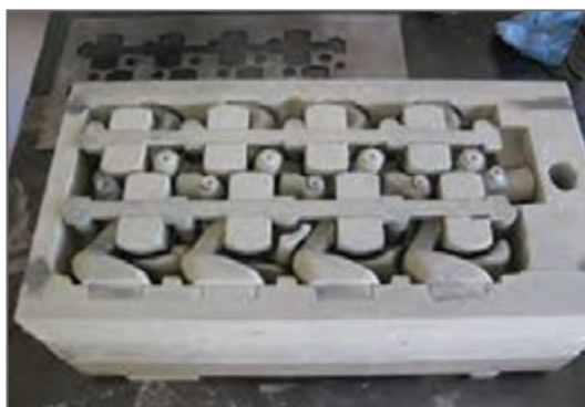
شکل ۲- قالب درجه زیرین یک قطعه صنعتی
