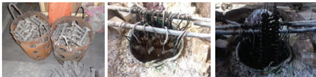
شکل ۲۶- تمپر کردن قطعات
