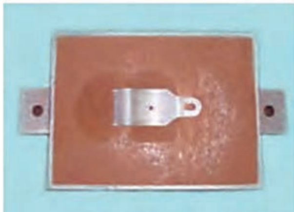
شکل ۲۱. سطح قالب‌های زیرین را پودر جدایش بزنید.
