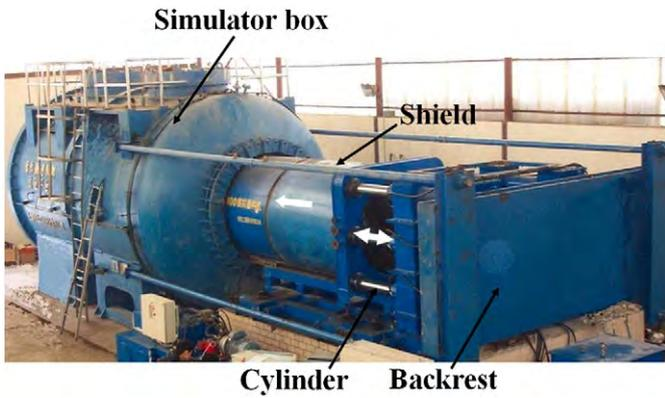
Fig. 10. Tunneling test rig.
